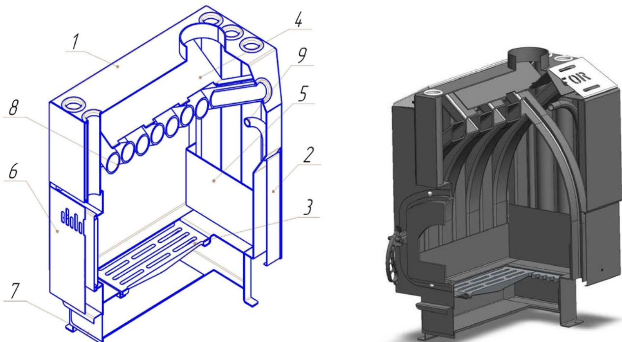
Рис.1- Общий вид в разрезе печи Ставр
